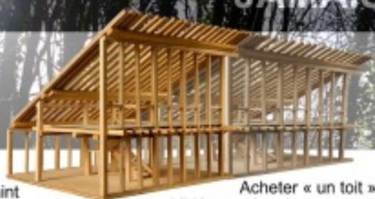
Acheter « un toit » : L'idée est de proposer un terrain délimité avec une zone d'implantation, un « bloc » habitable défini par une dalle, des poteaux et un toit.
