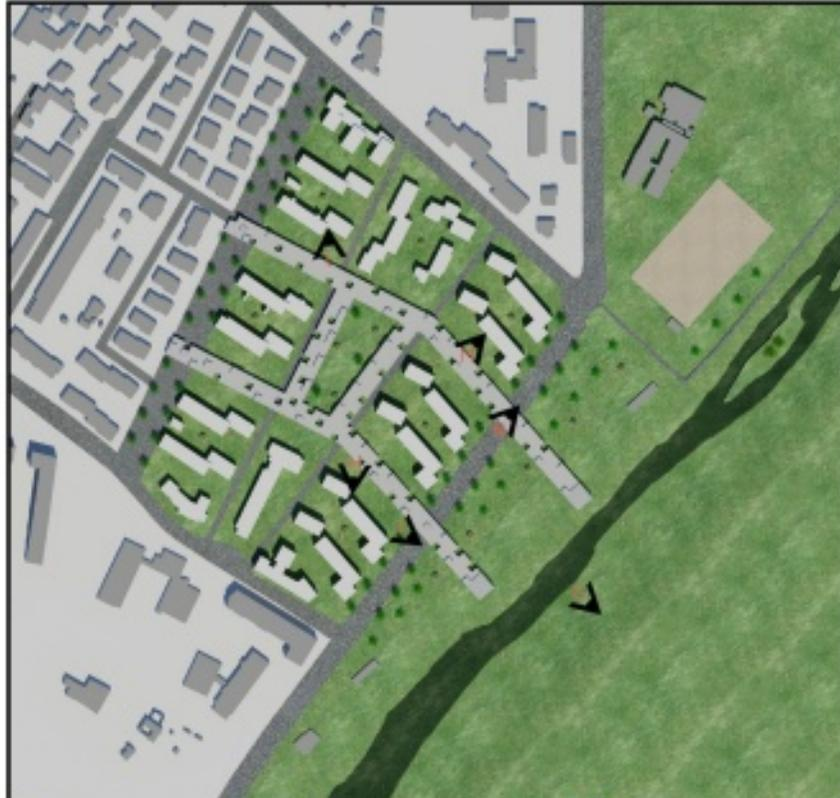
L'intervention de rétablissement de l'espace, qui se base sur une mise en relation des lieux et des constructions existentes, prévoit la réalisation d'un passage piéton qui respecte la géometrie du lotissement. Il est construit en démolissant seulement quelques immeubles, en utilisant les pilotis existents. Un certain dynamisme est perçu grâce à la présence soit de magasins et bureaux à l'altitude du passage, soit de la place du marché au-dessous.
